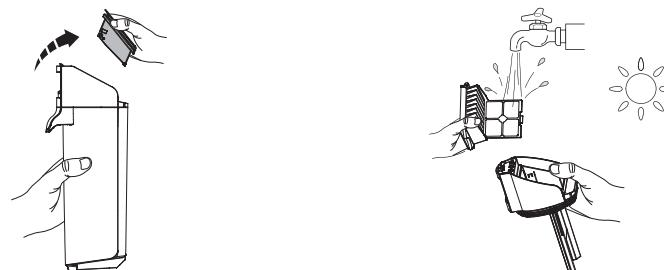
Afferrare l'area incassata su ciascun lato del filtro a secco e tirare verso l'alto. Risciacquare con acqua corrente e lasciare asciugare completamente prima di riutilizzarlo con il coperchio del serbatoio dell'acqua sporca.
