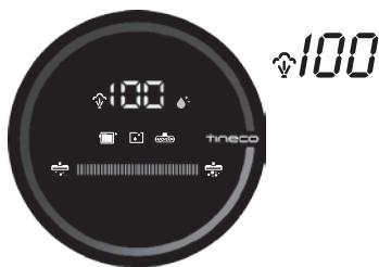
Dopo essere passati alla modalità Vapore, iniziano ad essere visualizzati i numeri. Dopo aver raggiunto 100, l'ugello inizia a spruzzare vapore.
