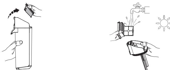
Segure a parte de encaixar de cada lado do filtro de ar seco e puxe para cima. Lave em água corrente e deixe secar completamente antes de voltar a combiná-lo com a tampa do DAS.
