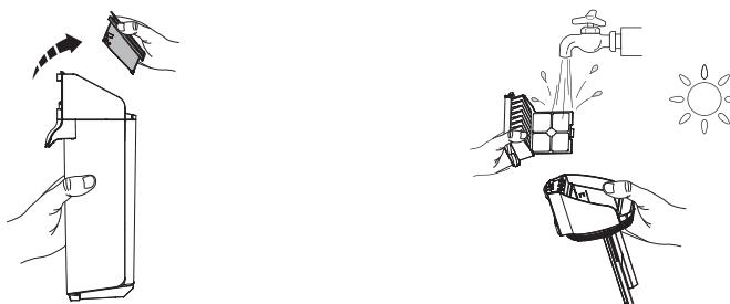
Sujete la zona rebajada de cada lado del filtro seco y tire hacia arriba. Enjuáguelo bajo el grifo y asegúrese de que está completamente seco antes de volver a combinarlo con la tapa del DAS.
