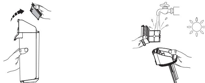
Fassen Sie den vertieften Bereich auf jeder Seite des Trockenfilters und ziehen Sie ihn nach oben. Spülen Sie ihn unter fließendem Wasser ab. Der Filter muss vollständig trocken sein, bevor Sie ihn wieder in den Deckel des SWB einsetzen.
